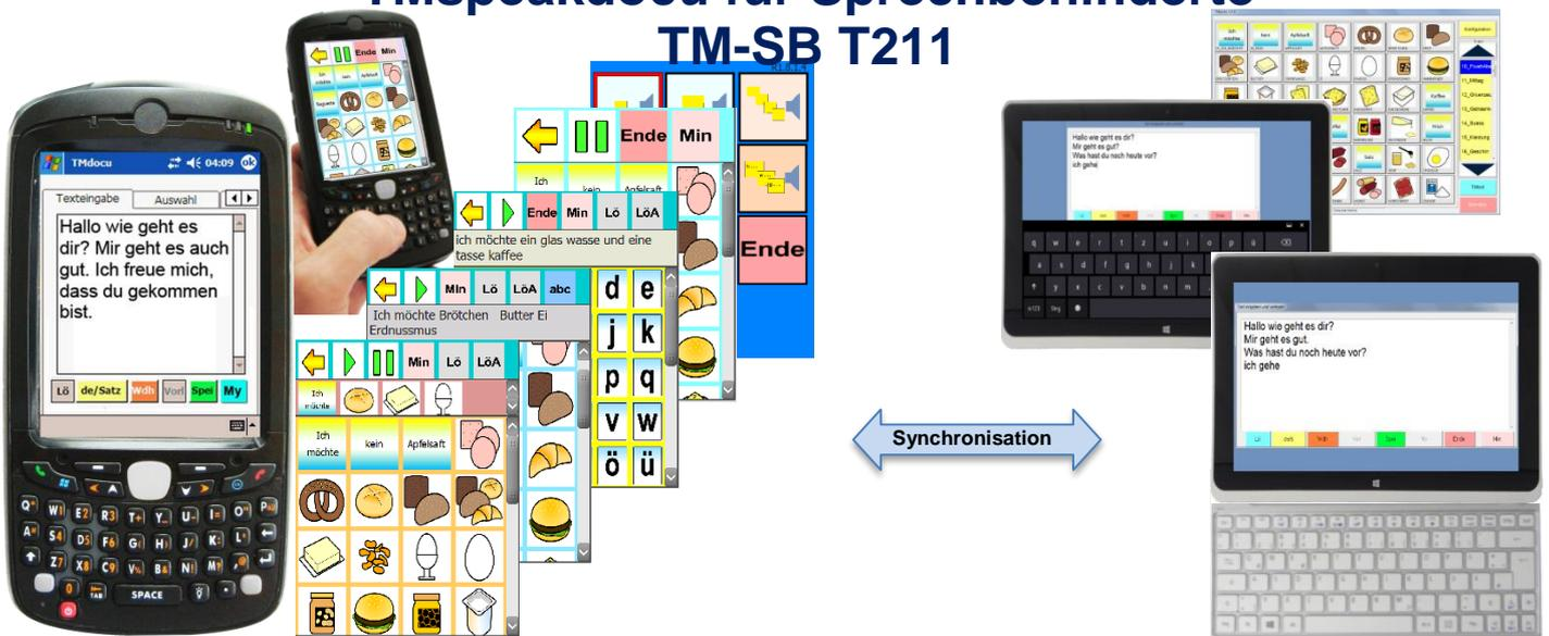
TM-SB T211 - **TMspeakdocu für Sprechbehinderte** ist eine robuste, handliche, mobile und leistungsfähige Kommunikationshilfe, die einen geschriebenen Text in Sprache umwandelt und vorgefertigte Redewendungen abspielt. Damit erhalten sprechbehinderte Personen eine Stimme.
